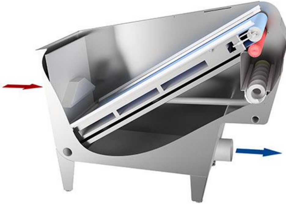
MYND 6 Sniðmynd inn í beltasíu, sem er dæmi um fíngerða síu. Þar rennur skólp um belti og seyra safnast fyrir í rými á enda beltis (mynd frá (Jacopa, 2018))
